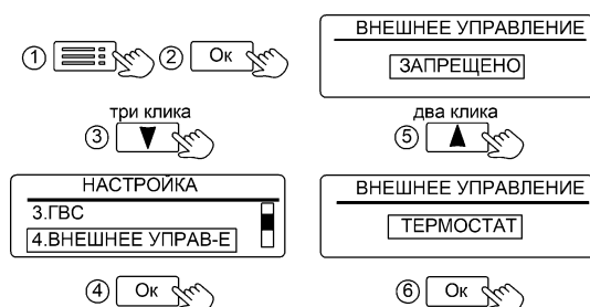
Рисунок 19. Настройка работы от внешнего устройства
