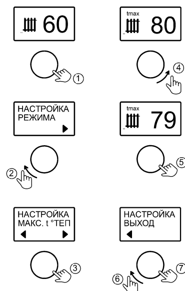
Рисунок 9. Настройка максимальной температуры теплоносителя
