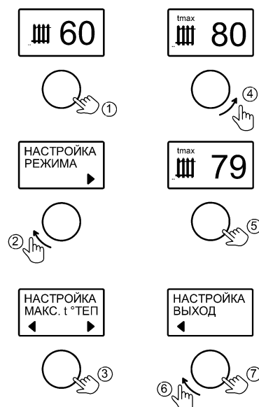
Рисунок 11. Настройка максимальной температуры теплоносителя
