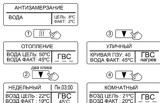
Рисунок 5. Режимы работы котла
