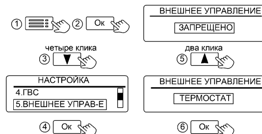
Рисунок 19. Настройка работы от внешнего устройства
